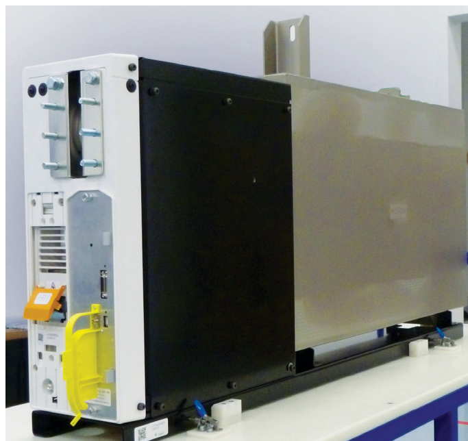
VSC sub module
