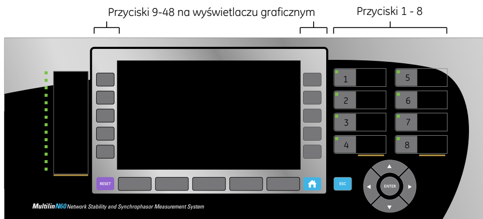
Rys. 5-58: Przyciski programowalne (panel graficzny)
