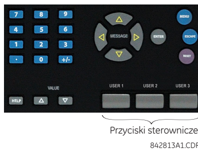
Rys. 5-53: Przyciski sterownicze (panel 2. generacji)
