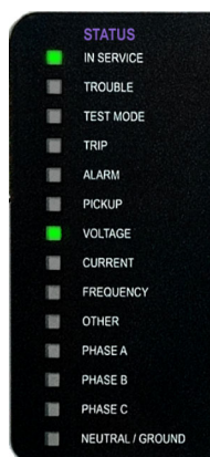
Rys. 4-51: Diody LED - graficzny panel przedni
