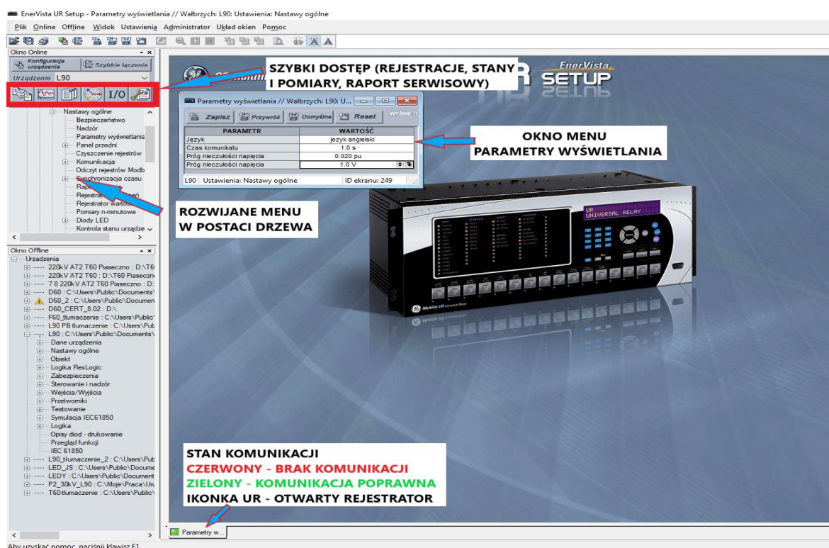
Rys. 3-68: Okno oprogramowania EnerVista UR Setup
