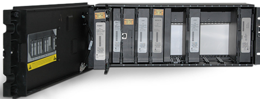
Rys. 10-15: Moduły wewnątrz urządzenia - widok z przodu (panel przedni 2. generacji)
