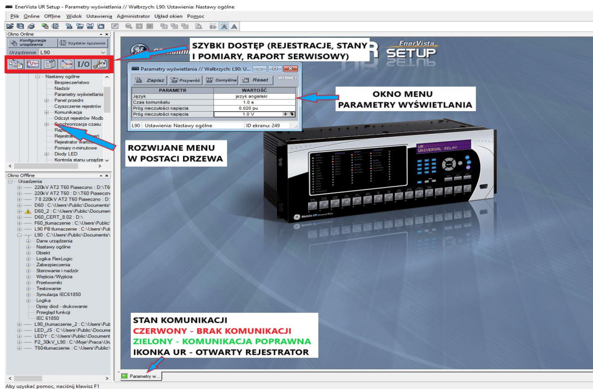
Rys. 3-71: Okno oprogramowania EnerVista UR Setup
