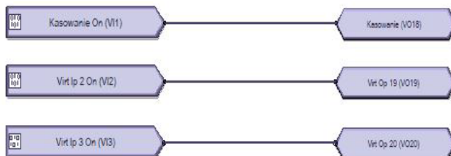
Rys. 4-74: Połączenie wejścia z wyjściem
