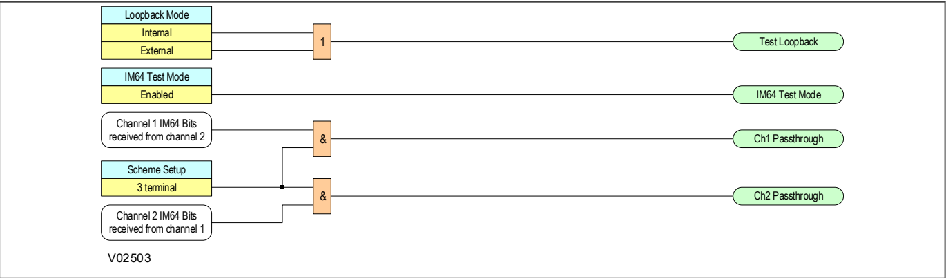
Figure 366: Logika ogólnych sygnałów alarmowych IM64
