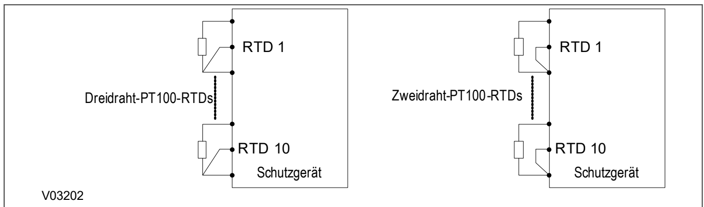
Abbildung 71: Anschluss der Widerstandstemperturfühler (RTDs)
