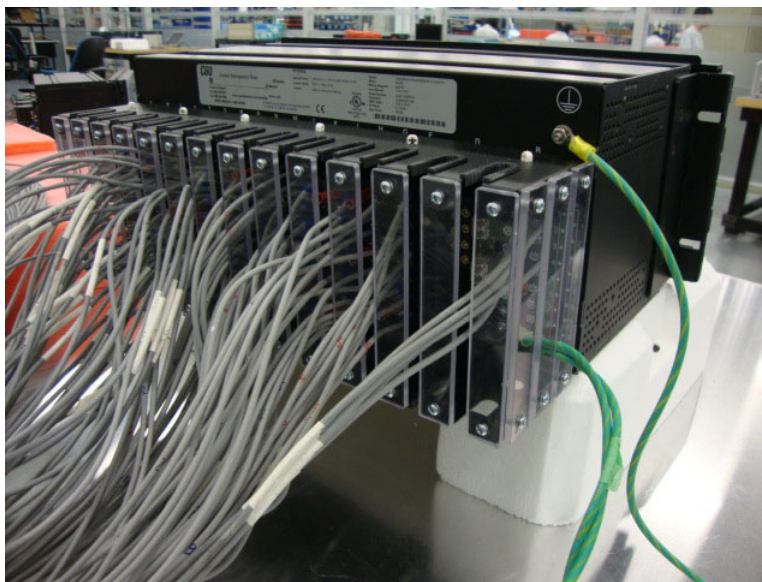
Figure 8: Capot IP20 installé avec sortie des câbles à l'arrière
