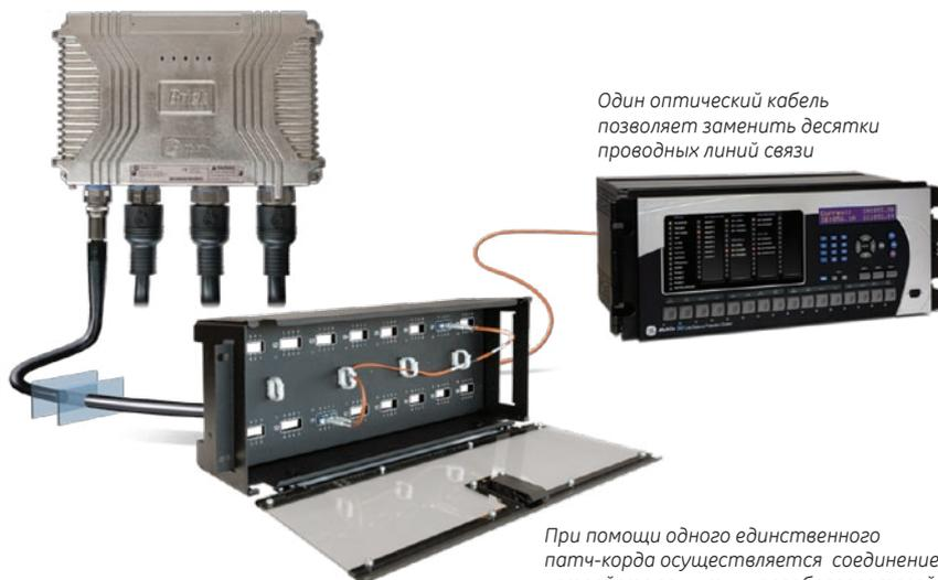
*Один оптический кабель позволяет заменить десятки проводных линий связи*
