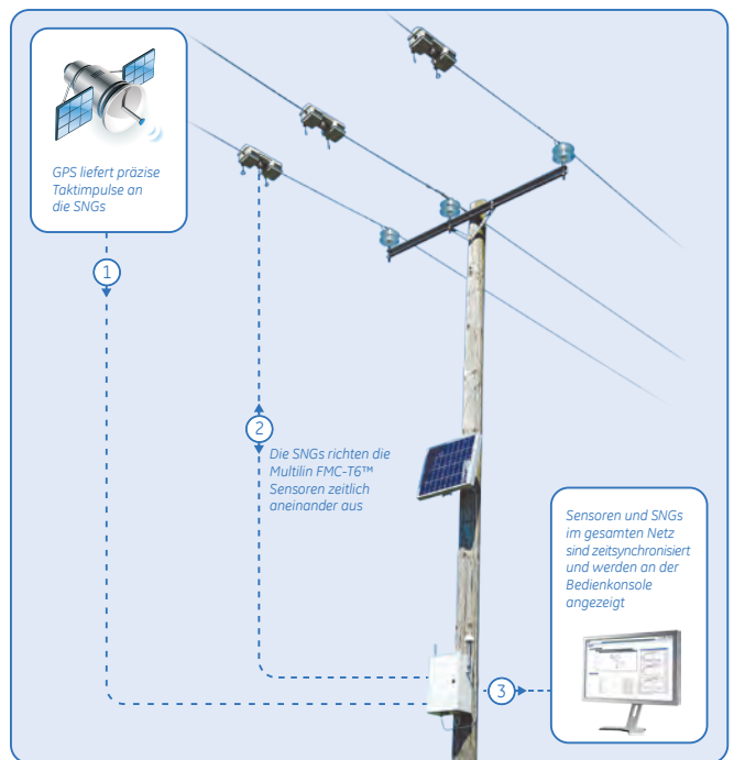
Typische Installation zur Messung des Abgangs
