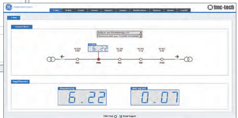
Die Anwendung liefert ortsspezifische Daten über Durchhang und lichte Abstand für die Überprüfung der Sicherheitsanforderungen und eine maximale Leitungsausnutzung
