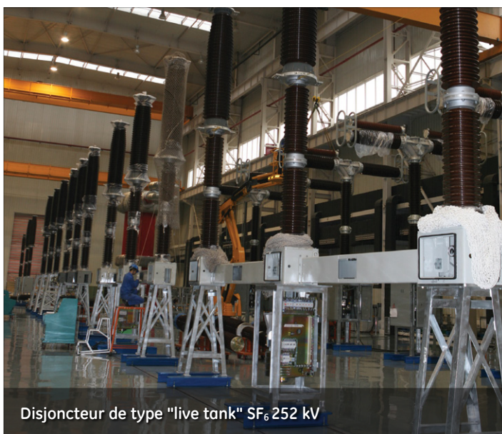
Disjoncteur de type "live tank" SF 6 252 kV
