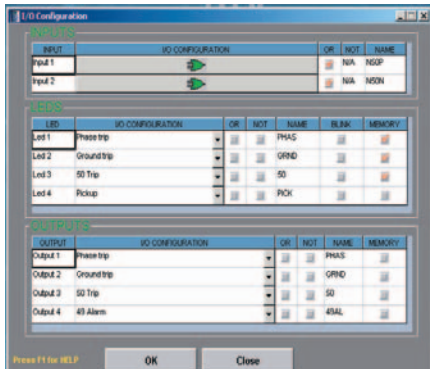
Entradas, salidas y LEDs pueden ser fácilmente configurables gracias al software EnerVista.
