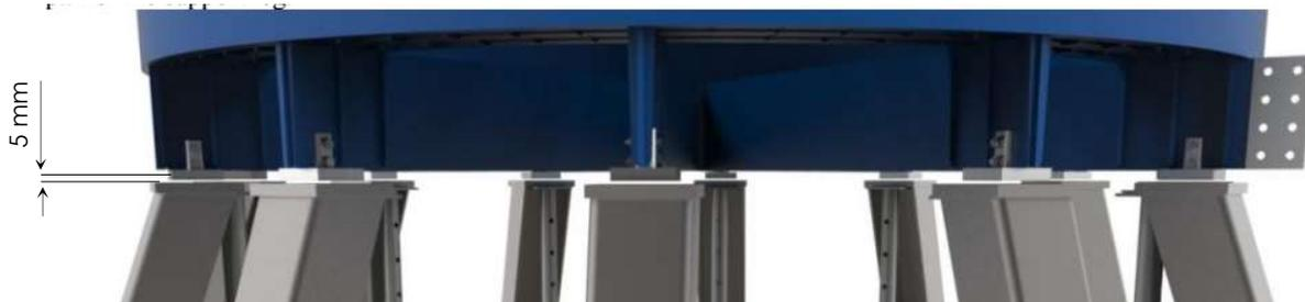
Figura 4: Distância de 5 mm entre a base do reator e estrutura suporte.
