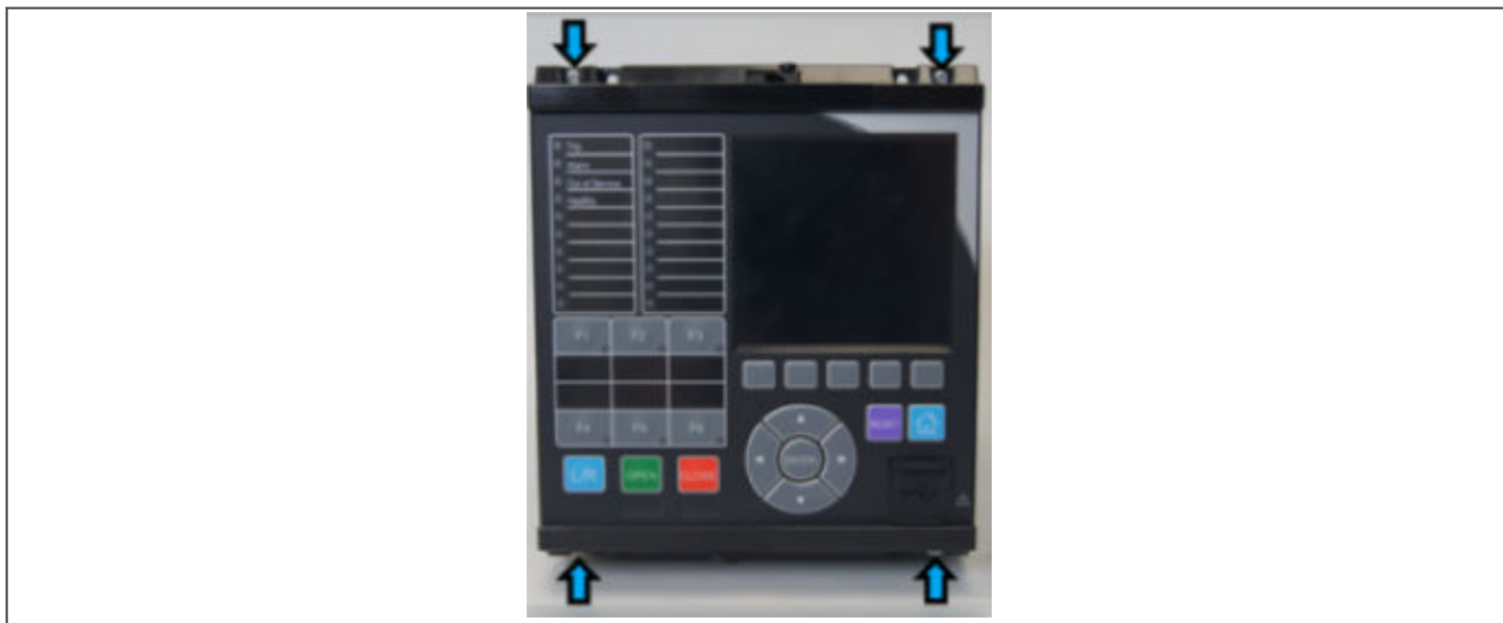
Figure 214: Rozmieszczenie śrub w 30TE (bez krzywki)
