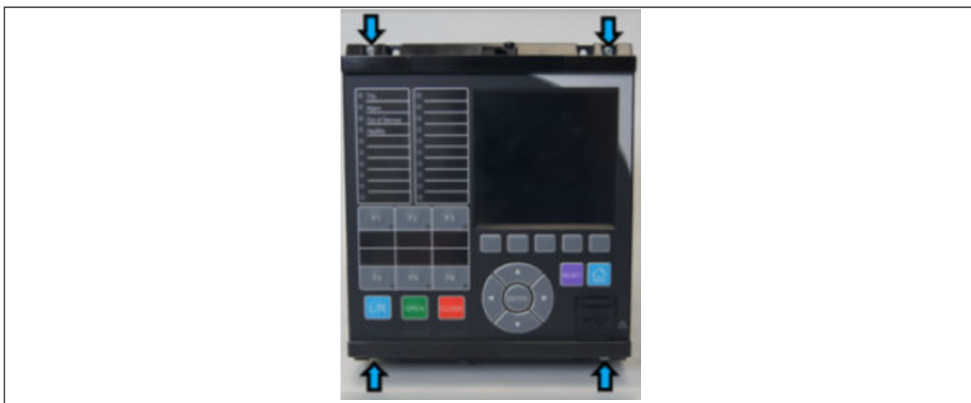
Figure 217: Rozmieszczenie śrub i krzywek w 30TE (z krzywką)
