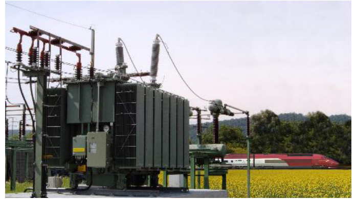
15 MVA 120/17,25 kV 16,7 Hz Hermetiktransformatoren für Bahnstrom-Unterwerke
