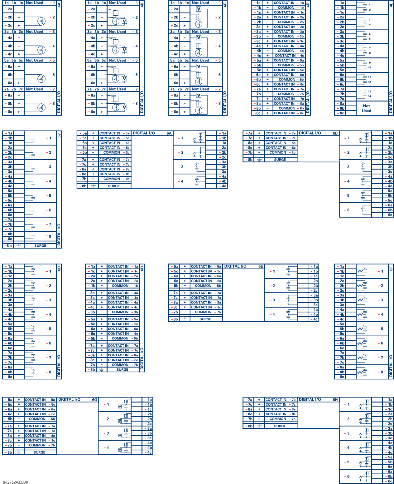
Şekil 3-14: KONTAK GİRİŞ VE ÇIKIŞ MODÜL KABLO BAĞLANTISI (1 / 2)
