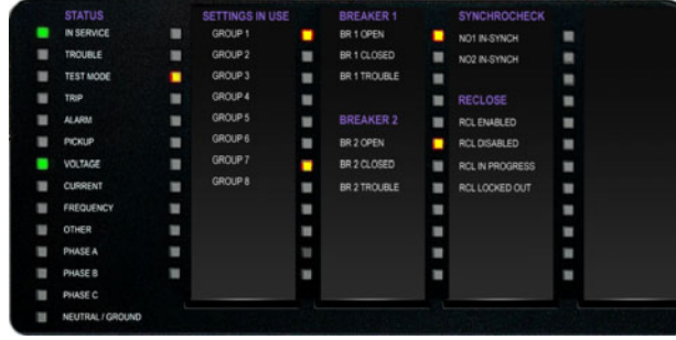
Şekil 4-17: GELİŞMİŞ ÖN PANEL İÇİN TİPİK LED GÖSTERGE PANELİ
