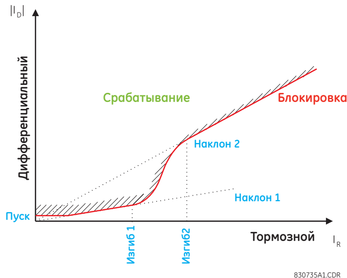
Рисунок 5–56: ДИФФЕРЕНЦИАЛЬНАЯ ЗАЩИТА СТАТОРА ХАРАКТЕРИСТИКА
