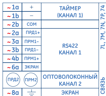
Рисунок 3–39: СОЕДИНЕНИЕ ОПТОВОЛОКОННОГО И RS422 ИНТЕРФЕЙСОВ
