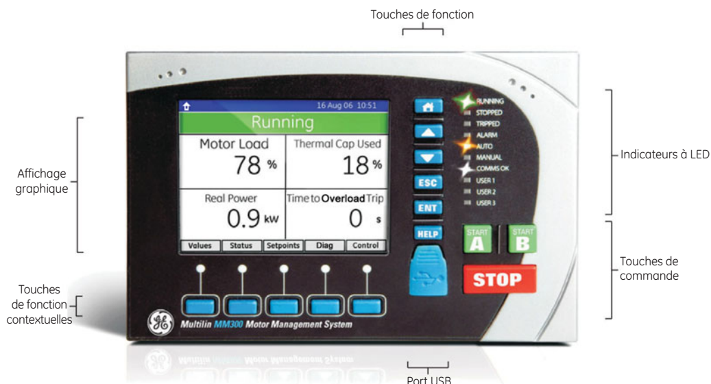
Figure 23 : Panneau frontal du MM300 avec un exemple d'affichage par défaut
